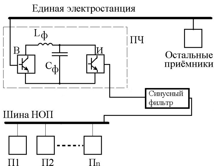
Рис. 5. Блок – схема преобразователя частоты, работающего на шину НОП
