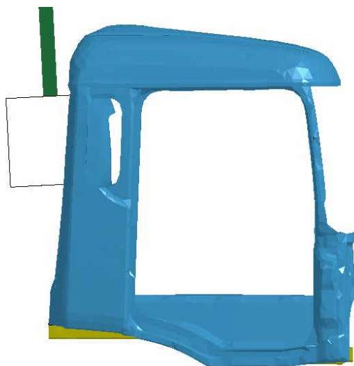
Рис. 4. Деформированное состояние доработанного варианта кабины
