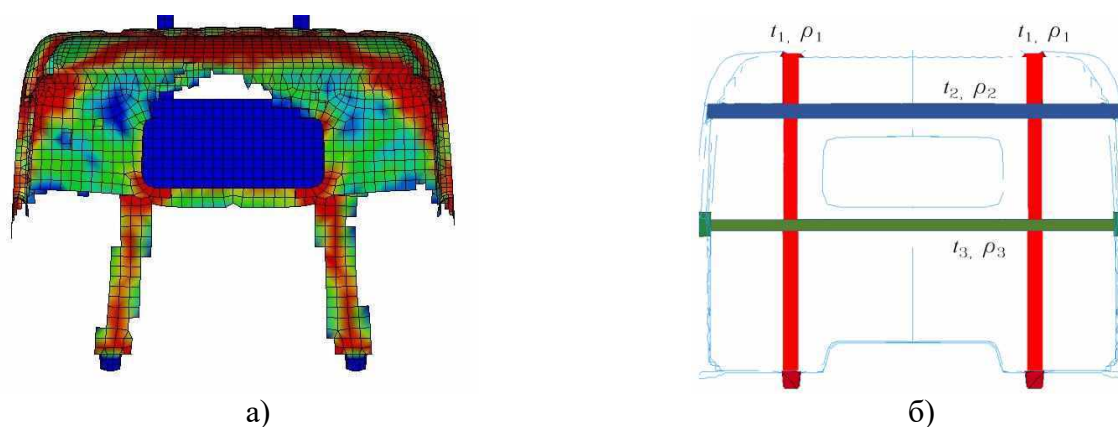
Рис. 6. Результаты: а – топологической оптимизации; б – интерпретации
